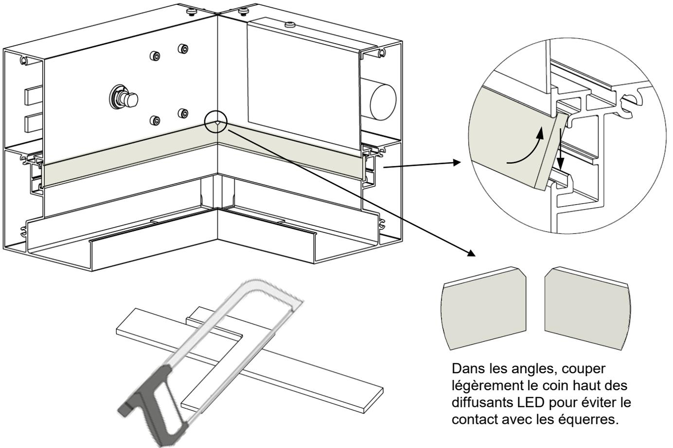
2 - Positionner les flasques d'angle au dessus des poteaux, pré-percer  $\varnothing 4$  au travers des trous de fixation, puis fixer avec les vis repère **G**.
