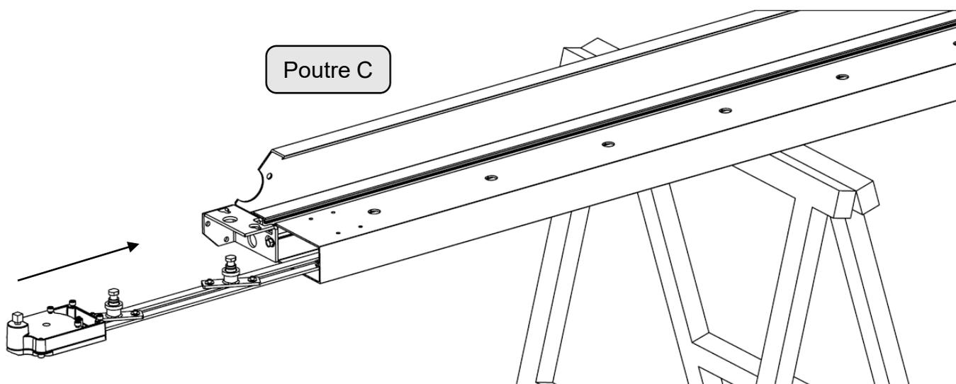
5 – Fixer le mécanisme sur la poutre C avec les vis repère Q.
