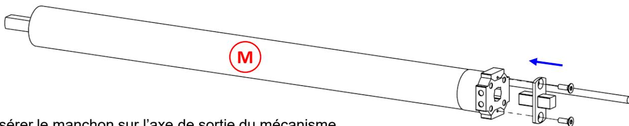
2 – Insérer le manchon sur l'axe de sortie du mécanisme.
