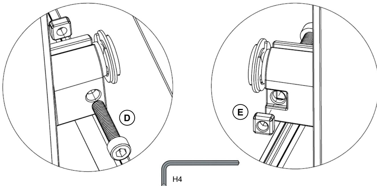
7 – Continuer l'installation des autres lames en suivant le même principe, embout mâle dans poutre D puis descendre l'embout femelle sur l'axe du mécanisme de la poutre C.
