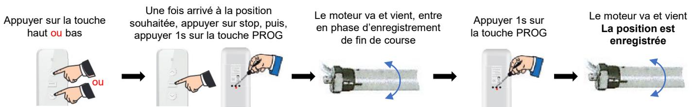
Réajustement de fin de course : (sans aucune action en 30s, le moteur sort de phase d'enregistrement)
