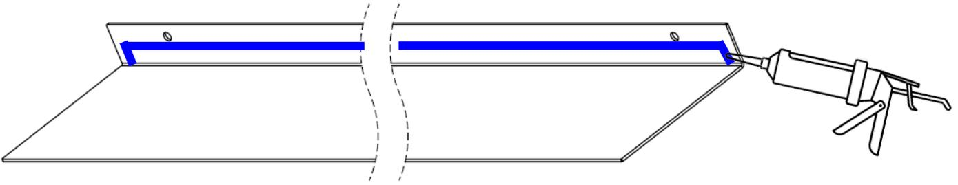
5 - Déposer un léger cordon de silicone de chaque côté de l'ouverture de la poutre.
