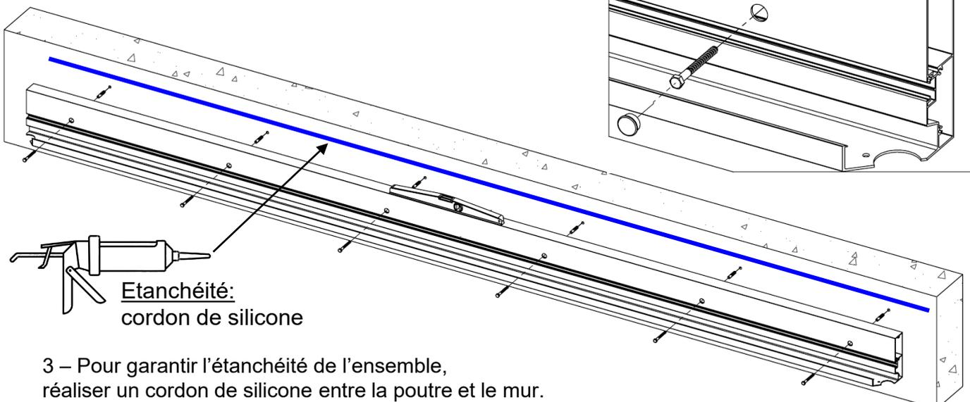
3 – Pour garantir l'étanchéité de l'ensemble, réaliser un cordon de silicone entre la poutre et le mur.
