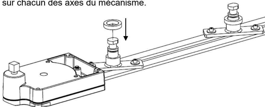
4 – Glisser le mécanisme dans la poutre C en faisant attention au sens, se repérer avec les trous de fixation puis faire sortir les axes par les trous dans la poutre.
