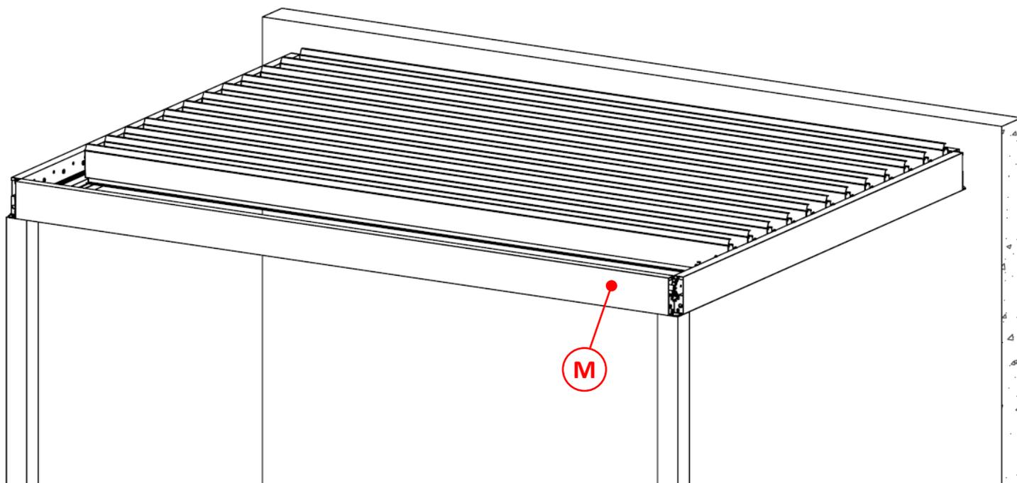
5 – Régler les positions d'ouverture et de fermeture des lames en suivant les instructions de réglage des fins de course du moteur page 22.
