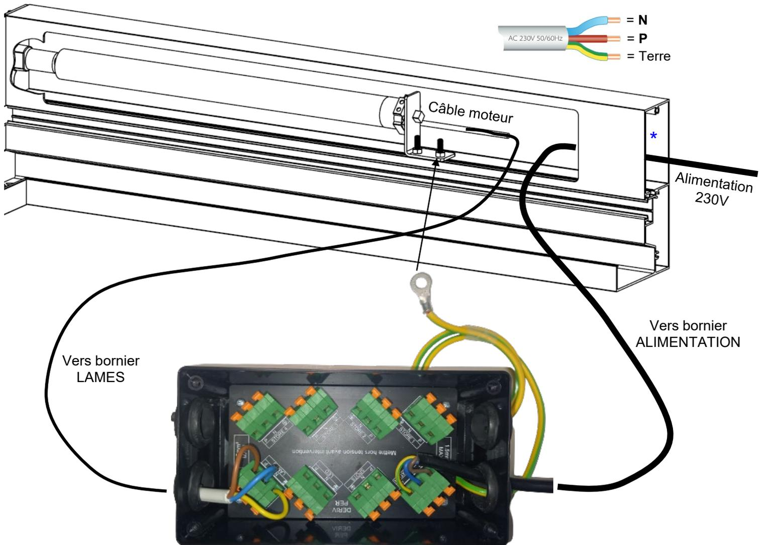
\* Le boîtier de raccordement se loge dans la poutre une fois tous les branchements effectués.
