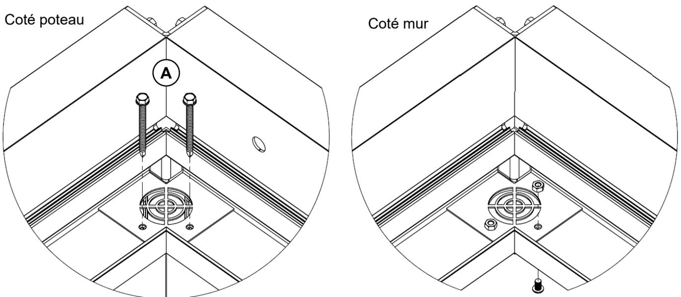
3 – Terminer en faisant un joint de silicone à la jonction intérieure des deux chéneaux.
