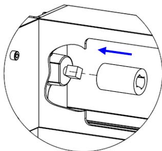
3 – Insérer le moteur dans le manchon puis faire glisser l'équerre et venir l'insérer sur l'axe carré à l'arrière du moteur de façon à avoir les boutons du moteur orientés comme sur la fig. 1. **Laisser un jeu d'environ 2 mm** puis serrer l'équerre. Faire passer le câble d'alimentation derrière l'équerre.
