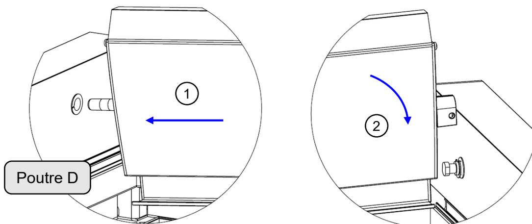
3 – Fixer la lame avec la vis repère **D** et l'écrou carré repère **E** à placer dans son logement.
