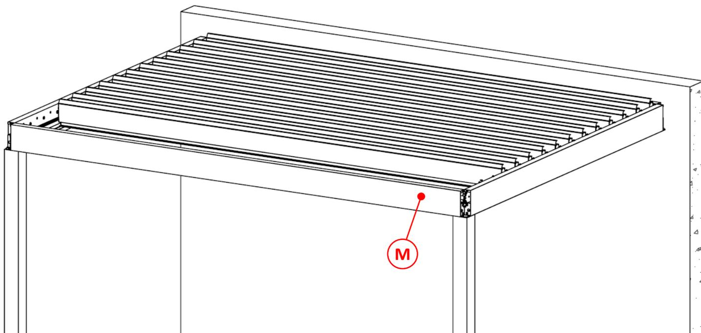
8 – Régler les positions d'ouverture et de fermeture des lames en suivant les instructions de réglage des fins de course du moteur page 22.
