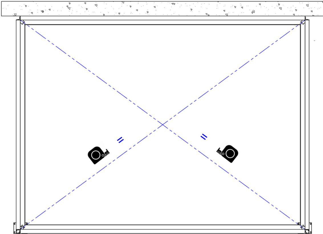
2 – Régler l'aplomb des poteaux puis le niveau de la structure, caler sous la platine si nécessaire.
