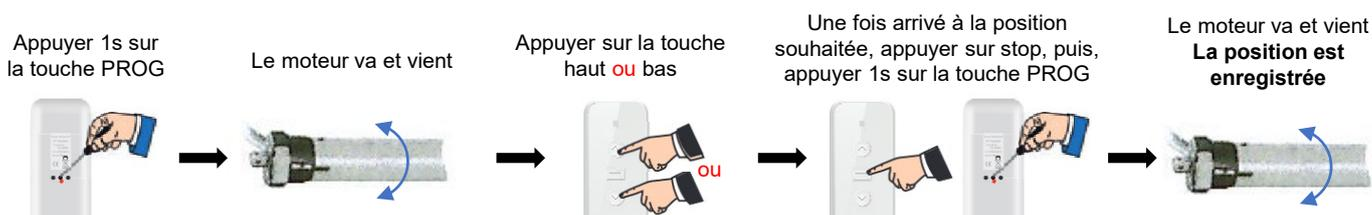
Enregistrement d'une autre fin de course : (sans aucune action en 30s, le moteur sort de phase d'enregistrement)
