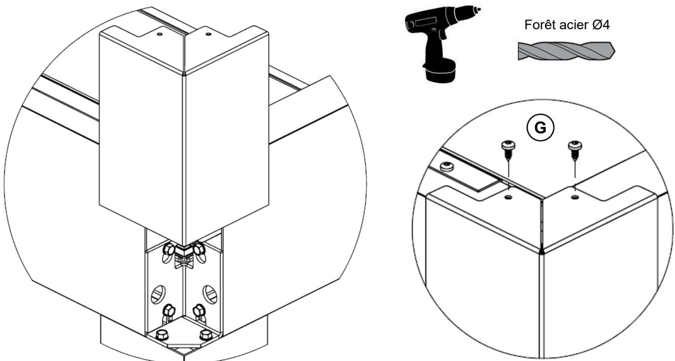
3 – Déposer un cordon de silicone sur la face intérieure basse des flasques murales puis les positionner dans les angles coté mur:
