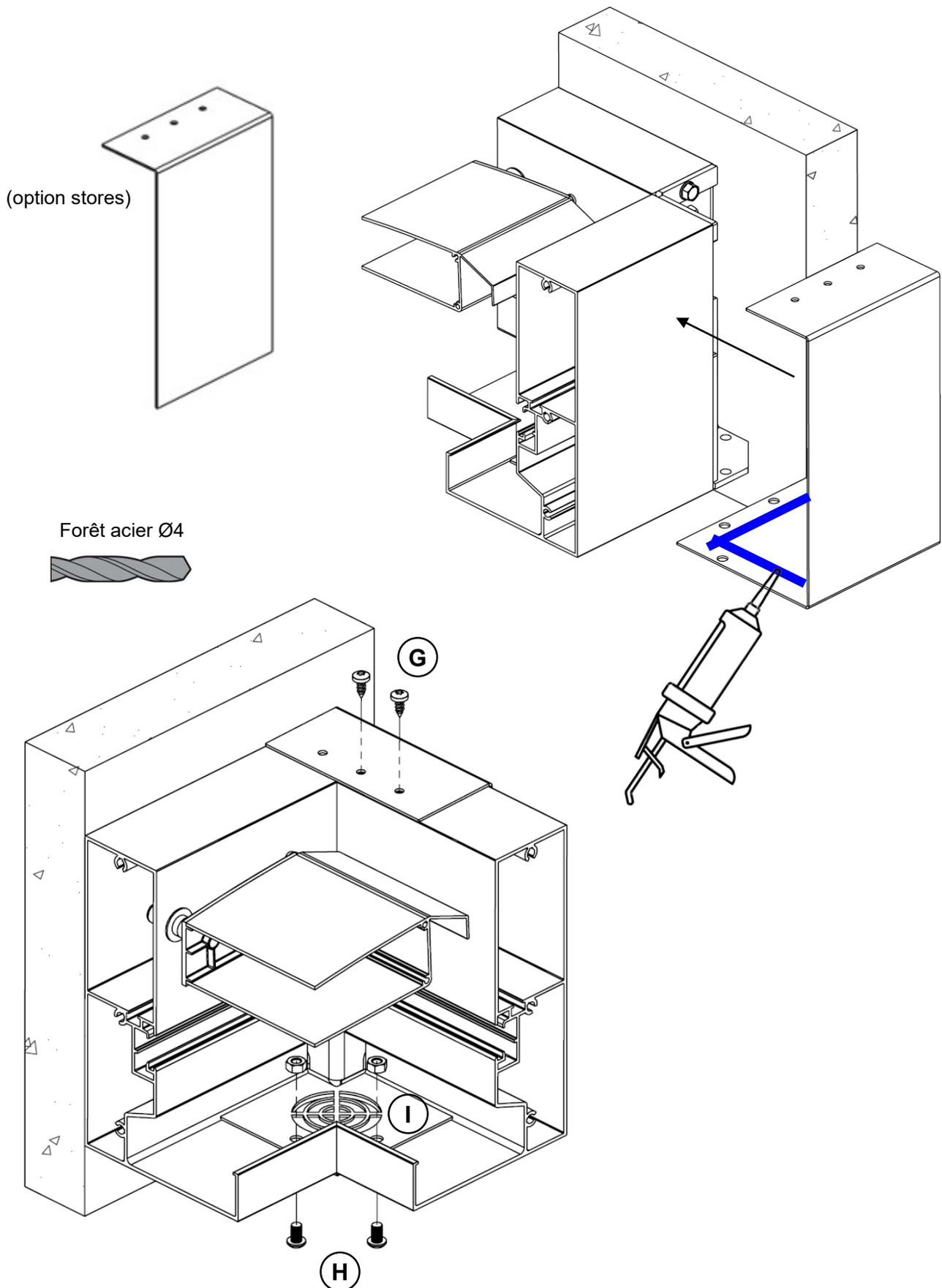
4 – Déposer un cordon de silicone sous le petit retour du capot moteur. Un silicone translucide est préférable, il ne sera pas visible en cas de débordement sur les cotés.
