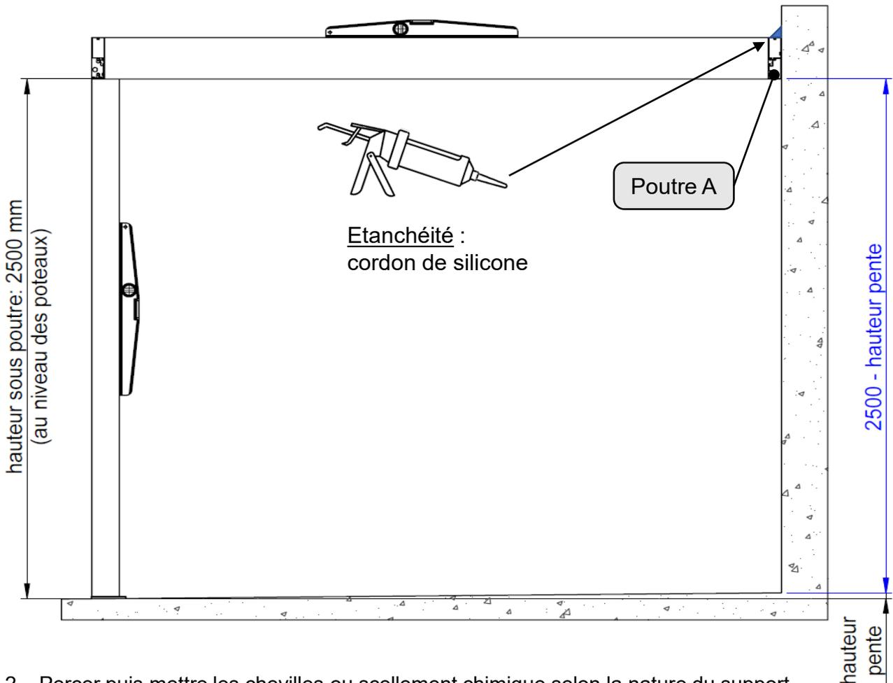
2 – Percer puis mettre les chevilles ou scellement chimique selon la nature du support fixer la poutre **A** de niveau. Mettre les bouchons plastiques.
