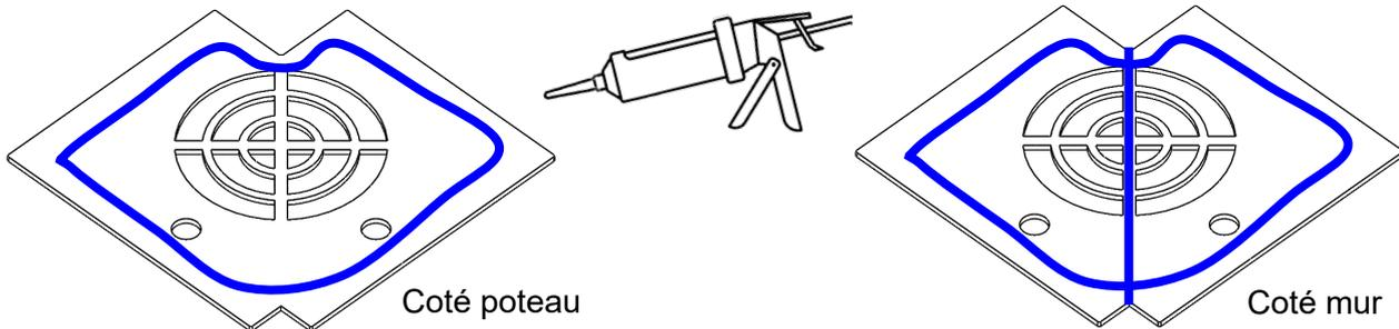
2 – Positionner les contreplaques dans les angles à l'intérieur des chéneaux (silicone entre contreplaques et chéneau) :
