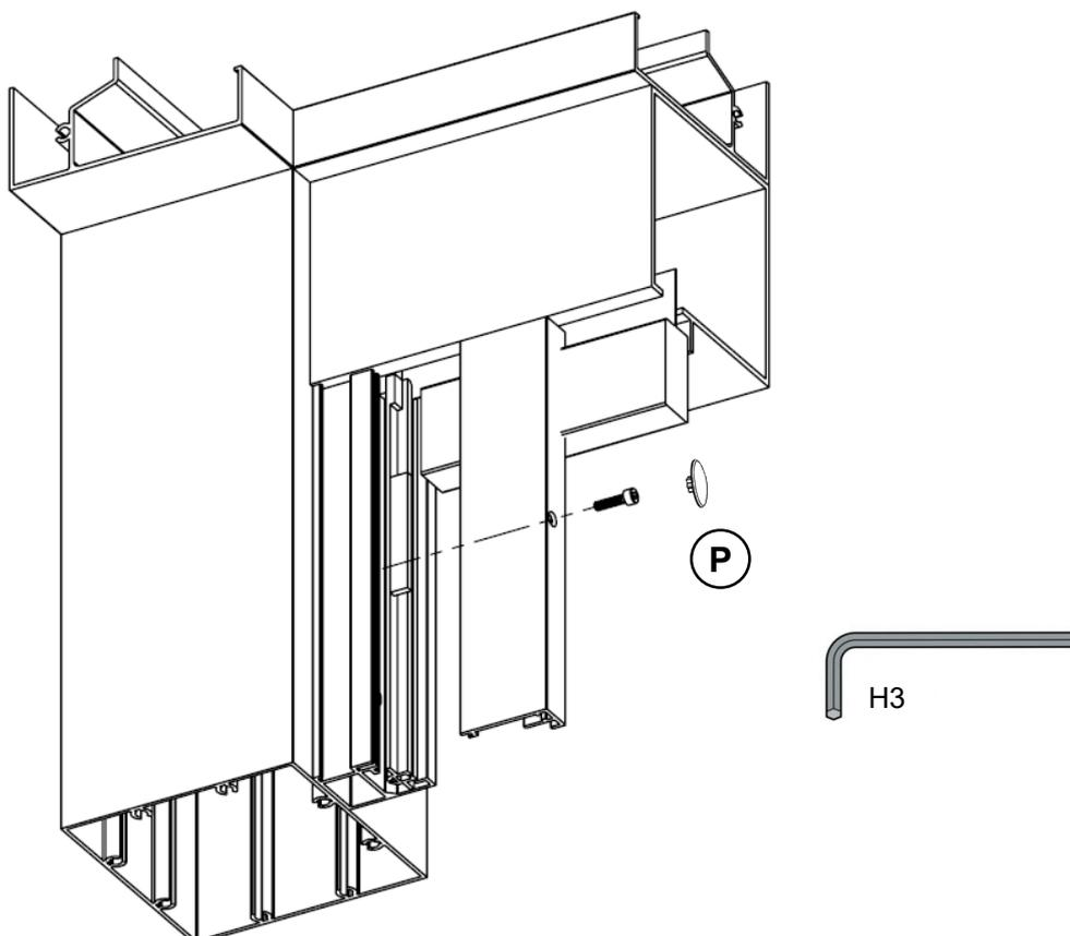
11 – Connecter le câble sur l'un des borniers « STORE » du boîtier de raccordement en le faisant passer dans les poutres, soit par la grande cavité, soit en dessous du bandeau LED.
