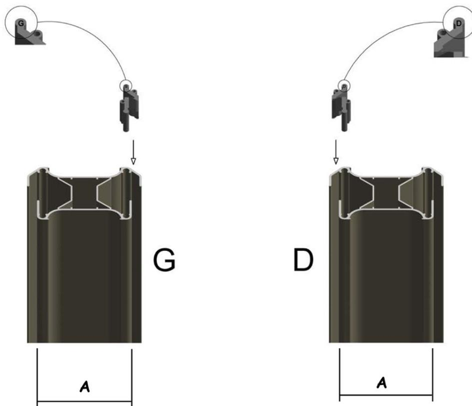
Les lettres D droite et G gauche sont prises en référence pour un panneau de clôture lorsque l'on se trouve à l'intérieur avec la partie étroite des poteaux A à l'intérieur de la propriété.
