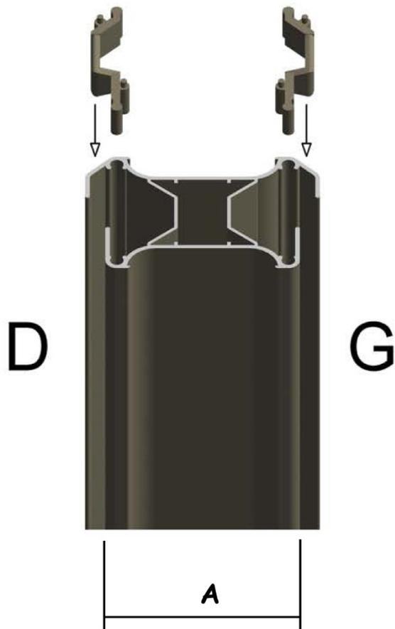
Face au poteau avec la partie la plus étroite face à vous (repérez «A» sur le schéma). Prendre l'entretoise avec la lettre D et la glisser dans les deux rainures cylindriques à gauche du poteau qui se trouve à votre droite.
